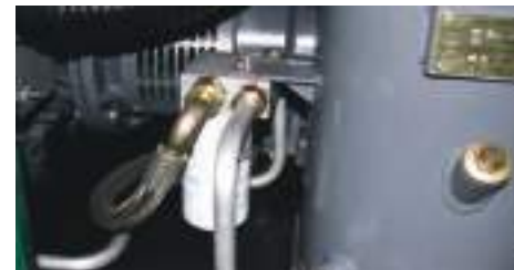
Montaje de filtro de aceite presenta componentes de alta eficiencia, 12µ, flujo completo, enroscable
